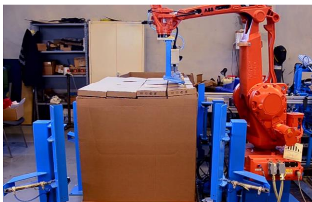
Slika 7. Robot IRB260 z vakuumskim prijemalom
