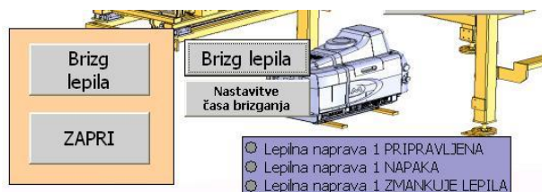
Slika 4. Lepilna naprava – prikaz na HMI vmesniku
