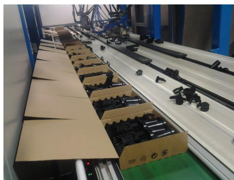
Slika 6. Zlaganje elementov na osnovi video sistema
