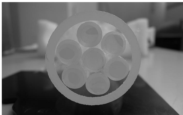
Slika 2: Test zlaganja palic v cev.
