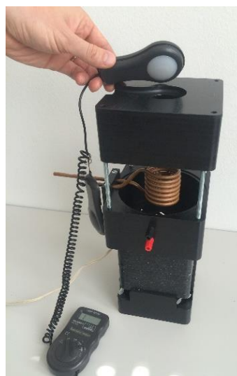
Slika 1: Slika odprte merilne komore z grelnim telesom in instrumentom za merjenje osvetljenosti.
