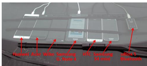
Slika 5. Postavitev pametnih telefonov in modula Bluetooth pod vetrobransko steklo
