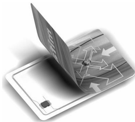
Slika 4. Zasnova brezkontaktna kartice (antena in mikročip)
