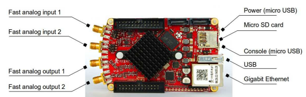
Slika 1: Strojna oprema odprto-kodnega merilnega instrumenta Red Pitaya [3].
