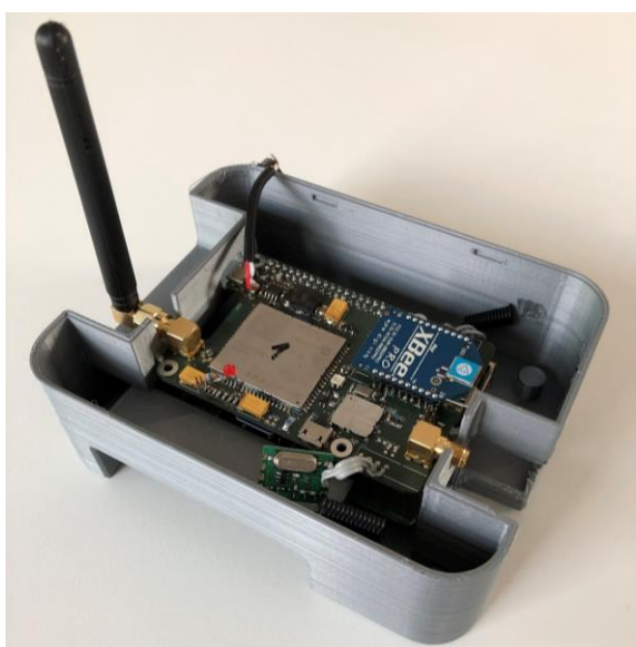
Slika 4: Tiskanina Enote umeščena v prvi prototip 3D tiskanega ohišja
