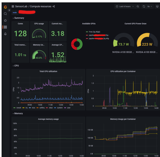
Slika 5: Nadzorna plošča Grafana s pregledom zasedenosti virov v zasebnem računskem oblaku.
