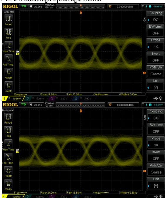
Slika 7. Primerjava očesnega diagrama v primeru pasivnega razcepnika (slika zgoraj) in v primeru AWG (slika spodaj) pri 20 km dodanega optičnega vlakna
