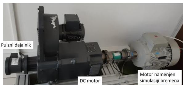
Slika 2. Enosmerni motor in motor, ki je namenjen simulaciji bremena.
