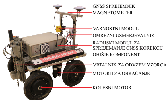
Slika 1: Postavitev elementov na mobilni platformi.
