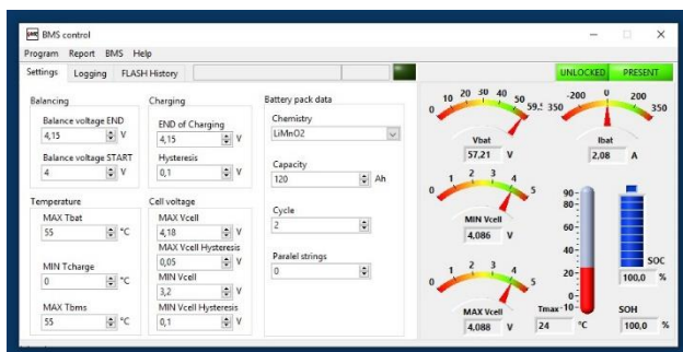
Slika 9: Uporabniški program za komunikacijo z BMS sistemom
