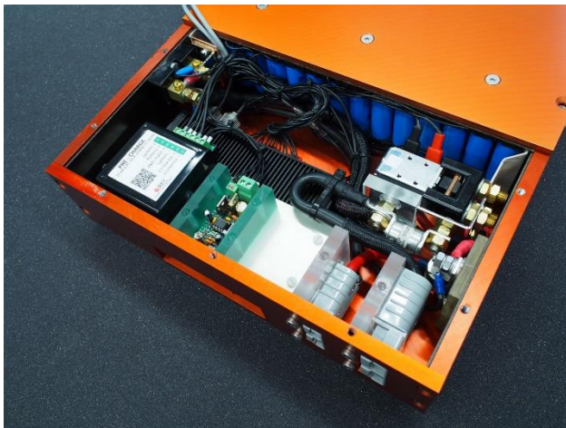
Slika 10: Baterija z vgrajenimi zaščitnimi vezji, BMS sistemom, močnostnim vklopnikom in konektorji
