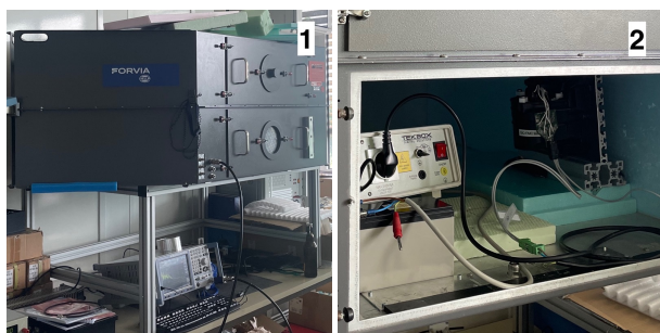
Slika 12: Preliminarno merjenje prevodnih emisij.
