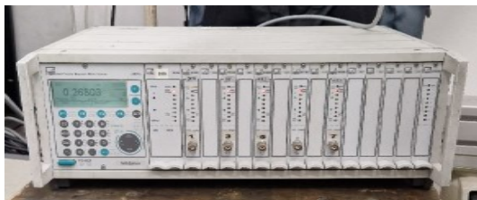
Slika 3. Merilni sistem HBM MGCplus z ojačevalnimi moduli HBM ML38B in HBM ML55B
