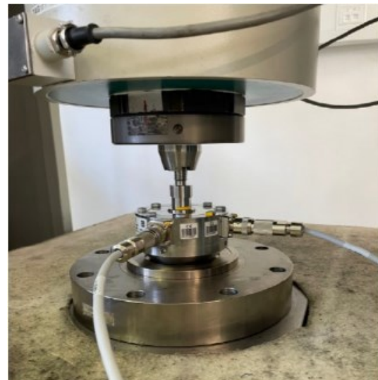
Slika 1. Merilni pretvornik sile HBM U10M v kalibracijskem stroju Zwick Z600E
