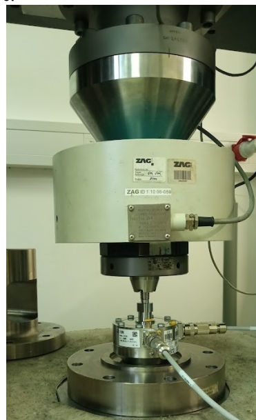
Slika 1. Merilni pretvornik sile HBM U10M v kalibracijskem stroju Zwick Z600E
