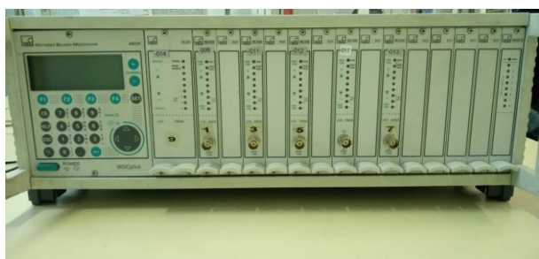
Slika 2. Merilni sistem HBM MGCplus z uporabljenimi ojačevalnimi moduli ML10B, ML38B in ML55B
