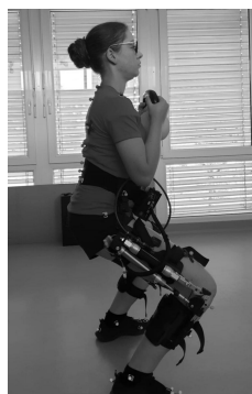
Slika 7: Primer enega počepa z utežjo, pri čemer ima oseba na sebi eksoskelet, EMG senzorje, ter reflektivne markerje za zajem gibanja.
