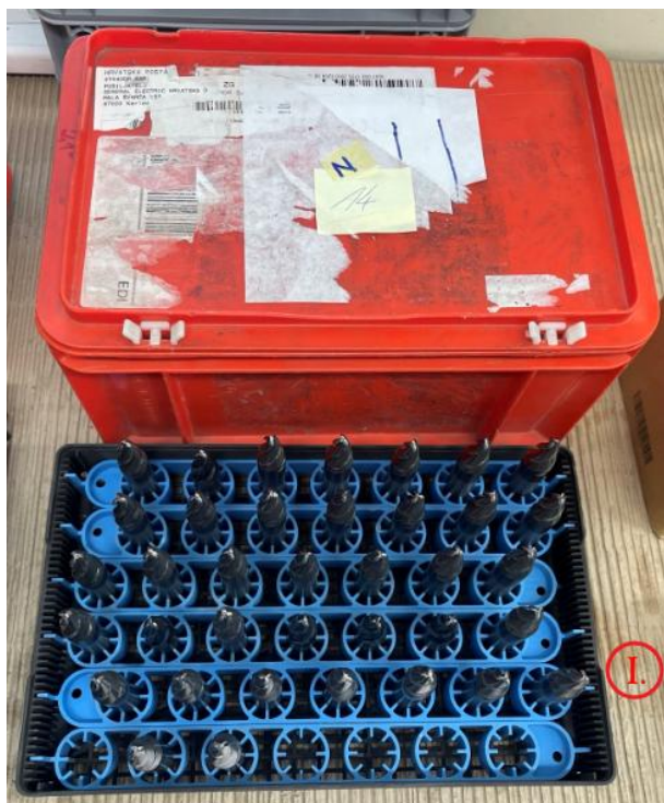
Slika 3: Primer sprejetega orodja (svedri), ki je po vhodni kontroli zložen v košarico za nadaljnjo obdelavo v PVD proizvodnji
